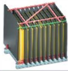
この検出器ではニュートリノと鉛核との荷電カレント反応(ちょっと難しい?)によって発生した荷電粒子を捕まえます。これで、ニュートリノビームの方向を測定することができます。
