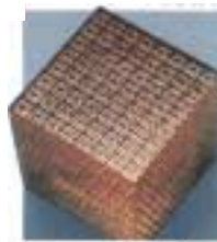
◀金属フォトニック構造体。その光学的性質は興味深く、盛んに研究されている。テラヘルツ光はその性質を調べる手段として有用である。
