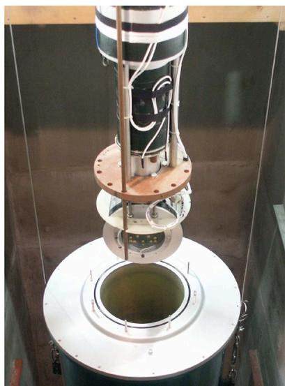
冷凍機の足下には深さ3メートルの穴が開いています。このように低い温度まで到達するためには室温から何段階もかけて冷却せねばならず、冷凍機自体が3メートル近い長さを持ちます。冷凍機本体も何重にも容器が重なった構造をしていますが、一番外回りに巨大な魔法瓶をかぶせて、液体ヘリウムを貯めることで冷凍を開始します。最低温度まで到達するには最速でも1週間以上かかる大仕事です。
